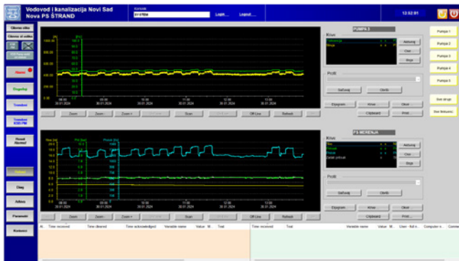
Pumpna stanica Štrand – parametri sistema, merenje struje, pritiska, protoka
